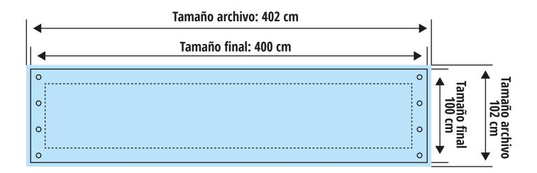
Área útil (aplicando distancia seguridad) Esquema orientativo. No realizado a escala.
